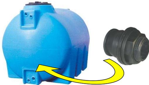
Il raccordo rapido ad innesto si utilizza con estrema facilità e rapidità praticando un semplice foro sulla parete (anche curva) della cisterna con una fresa a tazza secondo la tabella e inserendo il raccordo dall'esterno del contenitore
